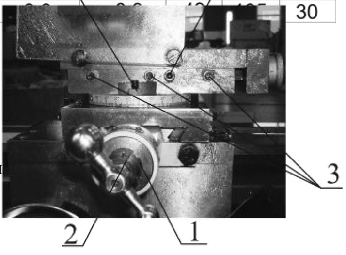
Люфт в передаче «винт-гайка» поперечных и продольных салазок регулируется гайками 1 и 2. Открутите гайку 2. Отрегулируйте люфт закручивая или откручивая гайку 1. Законтройте гайкой 2 (см. рис.11).
