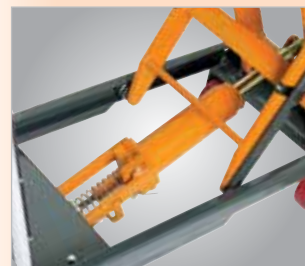
• Гидравлический подъем и опускание
