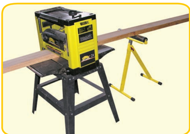
Пример использования роликовой опоры с рейсмусовым станком
